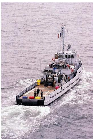
Conçu et mis au point à Lorient, L'Élan peut être utilisé dans le cadre d'assistances diverses : incendie, voie d'eau, sauvetage de personnes. Il peut également transporter du personnel (jusqu'à 10 passagers sur courte durée) et effectuer du transport de fret (60 tonnes en pontée sur la plage arrière en version cargo).
